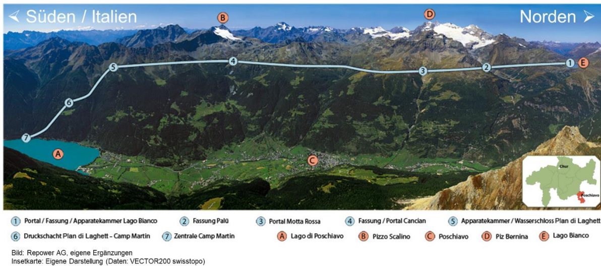
Abbildung 2: Querschnittsansicht durch das obere Puschlav mit dem geplanten Verbindungsstollen zwischen dem Lago Bianco (1) und dem Lago di Poschiavo (7) (Bildquelle: Repower AG sowie eigene Ergänzungen).
