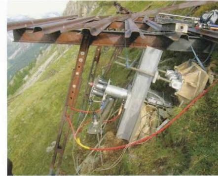
Abb 2: Zugprobe an einer bestehenden Schneebrücke, LV Munt da Lü.
