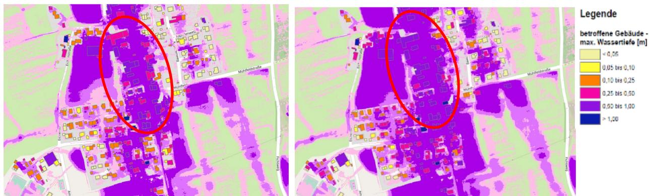
Abbildung 41a/b: Wassertiefen in den überfluteten Bereichen und Wasserstände an Gebäuden
