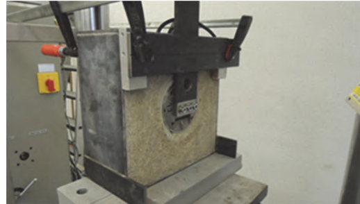
Abb. 6.11: Prüfstand TrafficLED Schubversuch
