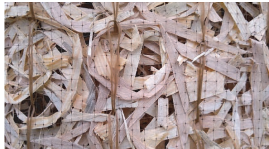
Abb. 4.17: Erosionsschutzmatte aus Holzfasern
