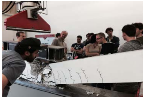
Abbildung 24: Versuche an einem Balken aus Stahl- beton
