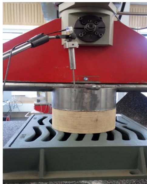
Abbildung 21: Prüfung eines Strassenrotes
