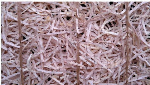
Abbildung 12: Erosionsschutz aus Holzwolle
