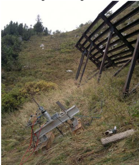
Abbildung 19: Ankerzugversuche, Mattstock in Amden
