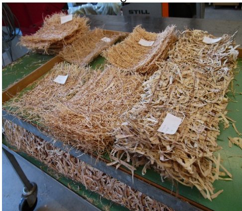
Abbildung 23: Testen von Prüflingen aus Holz- wolle nach ISO EN 10319
