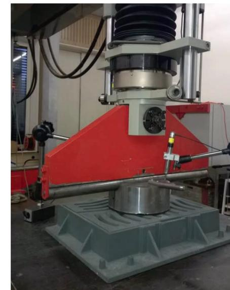
Prüfung von Schachtdeckeln für die Giesserei Chur AG im Druckversuch nach EN 124
