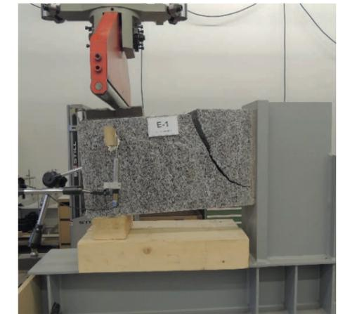
Biegeversuch an Konsolstein aus Calanca-Granit: Belastung bis zum Bruch
