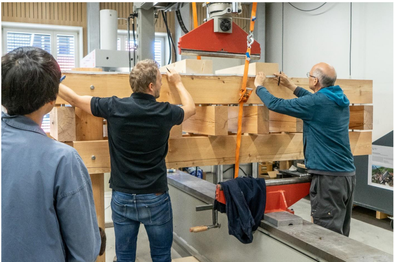
Aufbau des Holztragwerkes für die Bauteilprüfung
