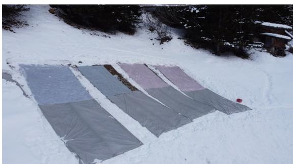
Abb. 1: Geotextilien auf Gleitschneehängen
