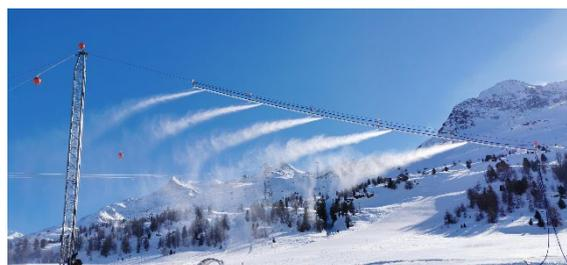
Abb. 7 Betrieb der Testanlage Diavolezza für die Versuche des ersten Prototyps eines Schneiseils
