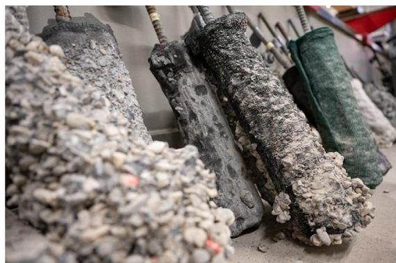
Abb. 6 Labor-Prüfanker mit diversen Geotextilsäcken
