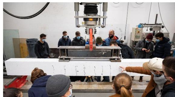
Abb. 19 Biegedruckprüfung
