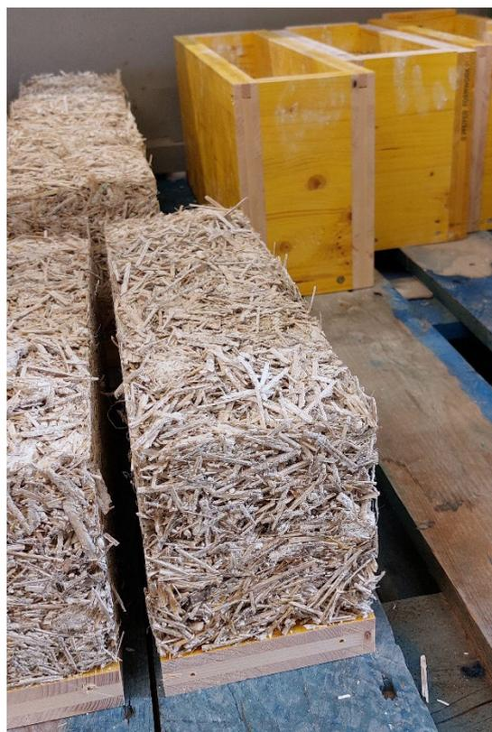
Abbildung 2 Frisch angefertigte Hanf-Dolomit-Mauersteine, teilweise noch in ihrer Form aus Schaltafeln
