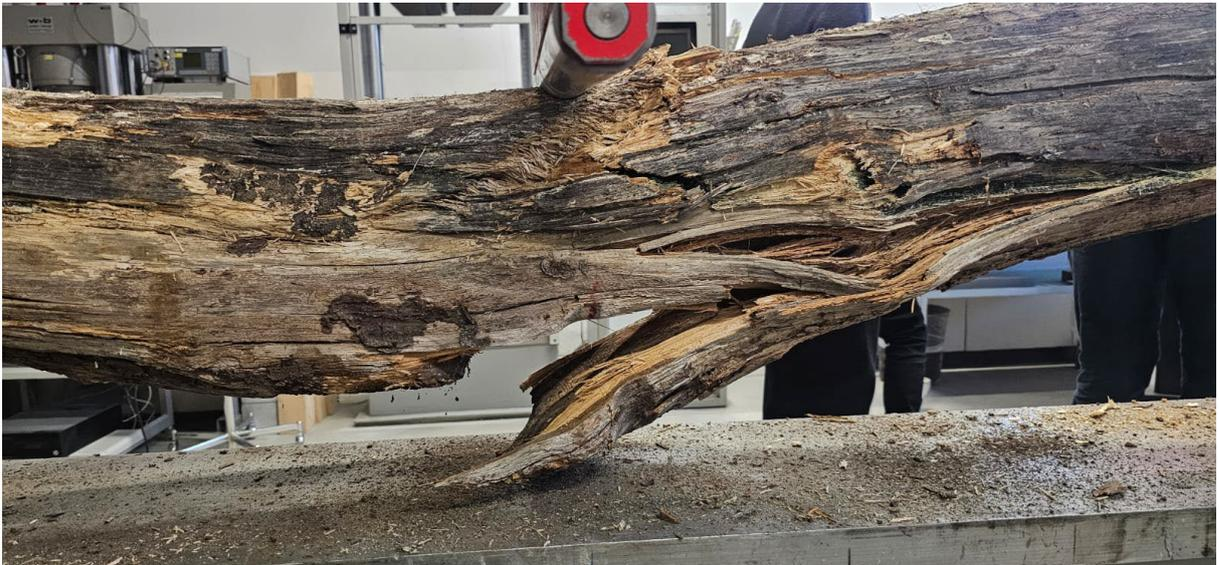
Abbildung 23 Bruch des Holzbalken aus der rückgebauten Holzpalisade.
