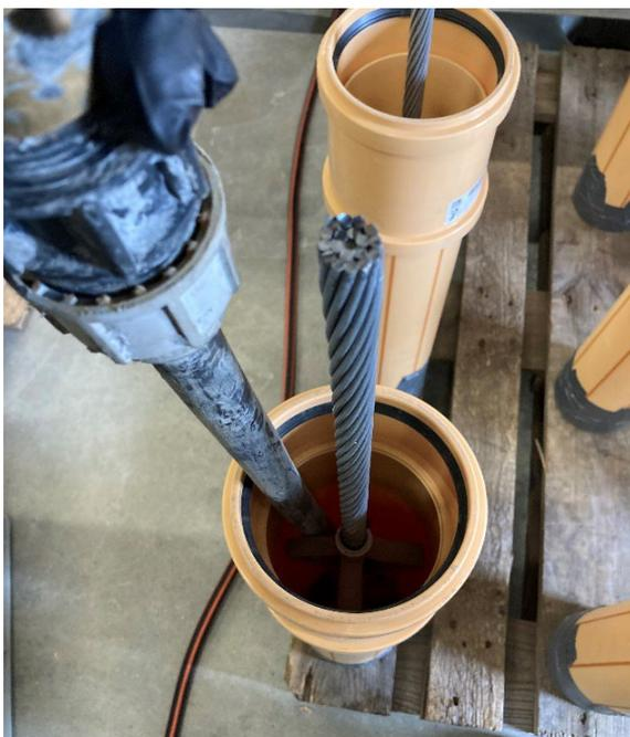
Abbildung 21 Einbetonieren der Stahlseile in Kanalrohre.
