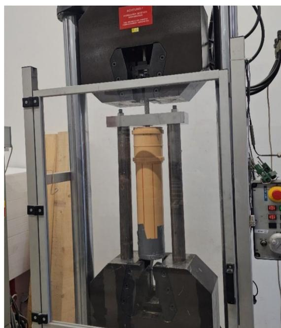
Abbildung 22 Zugversuch zur Ermittlung des Auszieh Widerstands.
