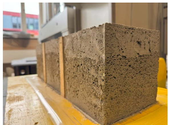
Abbildung 6: Vom IBAR hergestellter Schaumstoff nach Optimierung der Rezeptur
