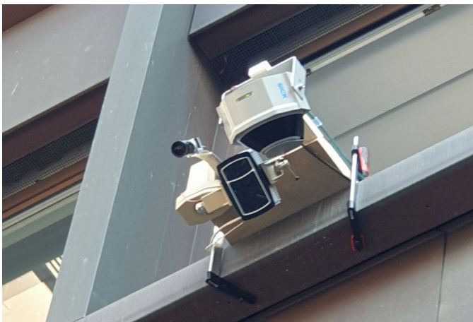
Versuchsaufbau mit Sensoren aller drei Technologien Time-of-Flight, LIDAR und 2D-Kamera (@ FH Graubünden)
