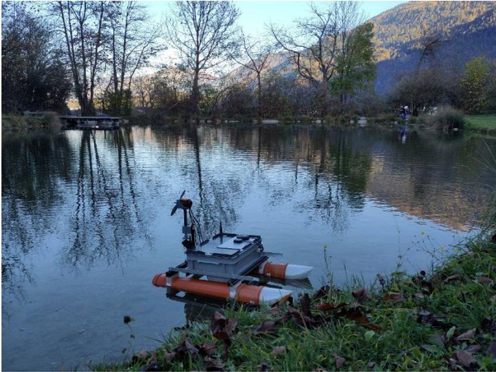
Foto des fortgeschrittenen Prototyps des USV bei einem Feldversuch in Bonaduz (Foto: Robin Derungs)
