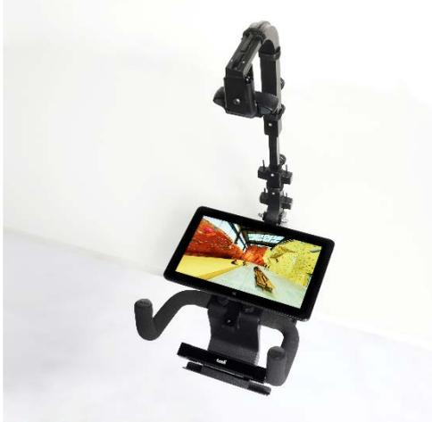
Abbildung 3: Eyetracking-Setup für mobile Endgeräte
