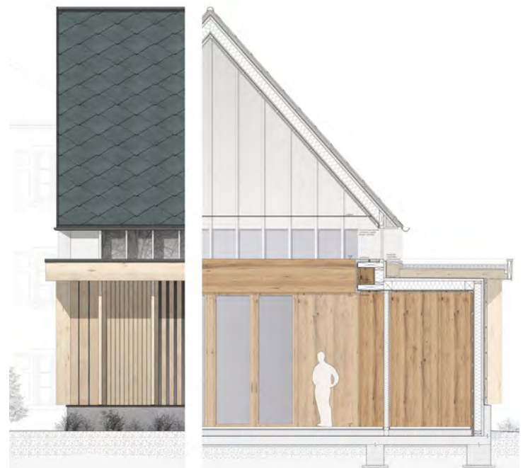
Fassadenschnitt | Sina Stecher
