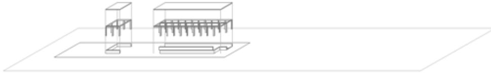
Der Kulturraum wird in einem Holz - Skelettbau geplant. Dies ermöglicht eine schnelle kostengünstige Fläche zu Verfügung zu stellen. Aus Beton wird das Fundament und der Sockelbereich gegossen, welcher die vertikalen lasten des Holzskelettes ins Erdreich leiten. Das Holzskelett wird durch flächige Füllungen und Windrispen ausgestellt. Das Sparrendach ist in sich selbst tragend und wird auf die vertikalen Holzstützen gestellt.
