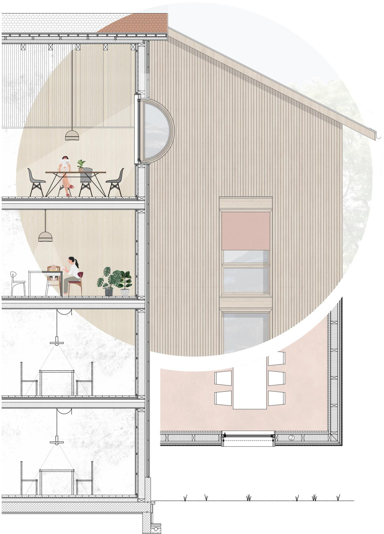
Detailschnitt / Fassade Neubau
