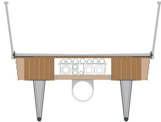
Abb. 4: Querschnitt mit Unterspannung
