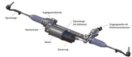
Elektromagnetisches Lenkgetriebe 1er/3er BMW (Baureihe F20/F30)
