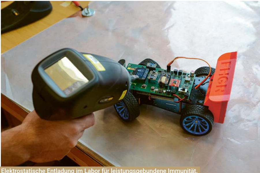
Elektrostatische Entladung im Labor für leistungsgebundene Immunität.
