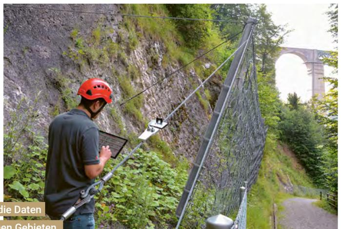
Der GUARD misst Einschläge und Korrosion an Schutznetzen und liefert die Daten an das Dashboard – für eine gezielte Wartung auch in schwer zugänglichen Gebieten.
