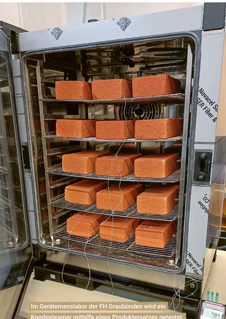
Temperaturmessungen im Gerätemesslabor: Hier werden unter anderem Fritteusen auf ihre Energieeffizienz getestet.
