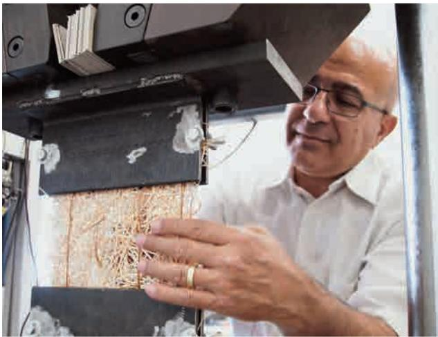
Versuche zur Tragfähigkeit und zum Wasseraufnahmevermögen der Holzwollmatten wurden im Mai und Juni 2014 im Baulabor der HTW Chur durchgeführt. (Bild: Flurina Simeon, HTW Chur)
